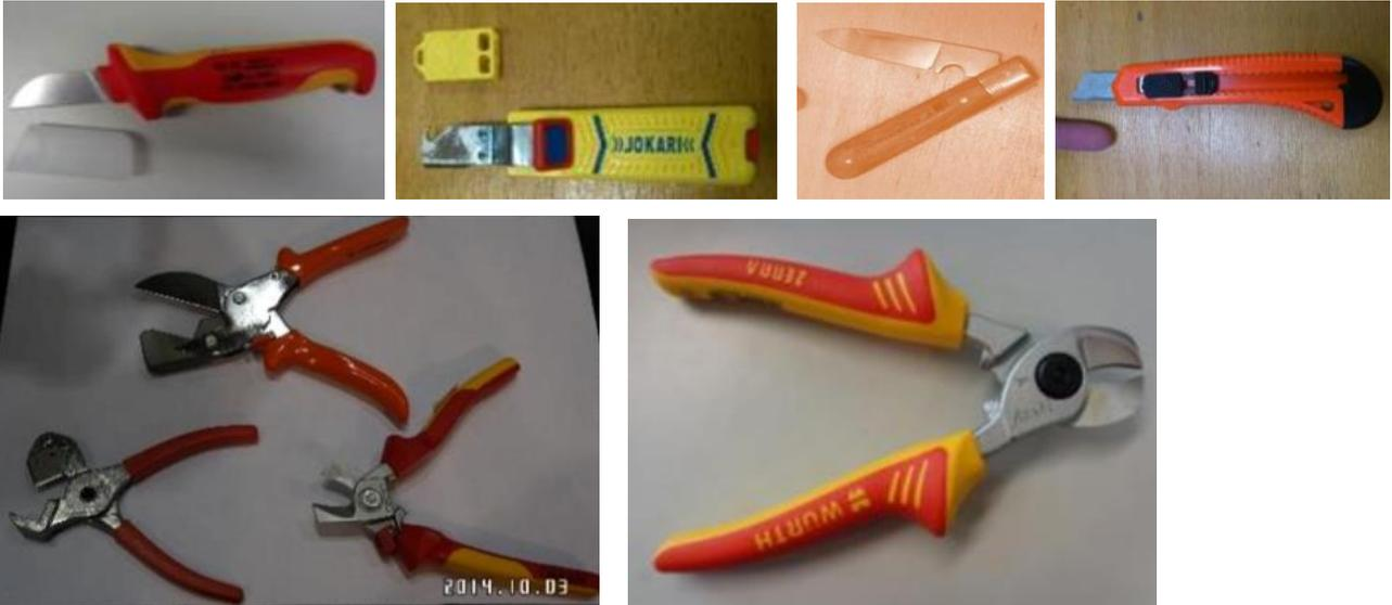
L'utilisation de coupe tube ne pourra se faire que si l'outillage a été conçu pour limiter la course d'ouverture afin de n'y pouvoir couper qu'un tube pneumatique inférieur ou égal à 6 mm de diamètre extérieur.
