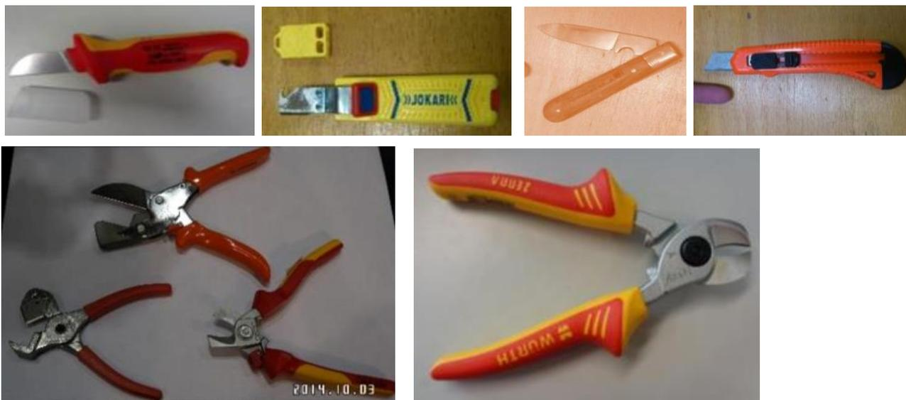
L'utilisation de coupe-tube ne pourra se faire que si l'outillage a été conçu pour limiter la course d'ouverture afin de n'y pouvoir couper qu'un tube pneumatique inférieur ou égal à 6 mm de diamètre extérieur.
