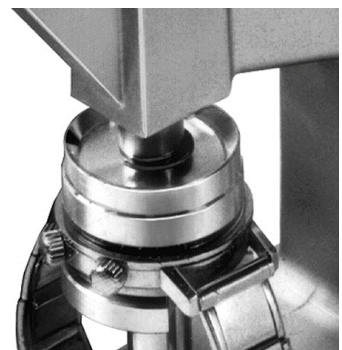
Pose d'un verre sur une montre
