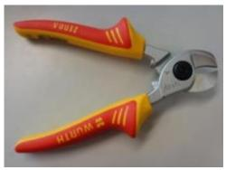
L'utilisation de coupe-tube ne pourra se faire que si l'outillage a été conçu pour limiter la course d'ouverture afin de n'y pouvoir couper qu'un tube pneumatique inférieur ou égal à 6 mm de diamètre extérieur.
